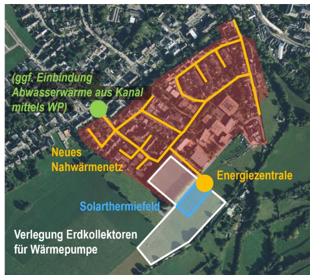
Abbildung 80: Beispielhaftes Nahwärmeconcept für das Schulviertel in Kornelimünster mit einem Solarthermiefeld sowie einem (nach Installation wieder nutzbaren) Erdkollektorfeld für eine Wärmepumpe. Möglich ist zudem die Einbindung von Abwasserwärme aus dem Kanal in der Schleckheimer Str.
