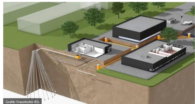
Abbildung 86: Schematische Darstellung von Erdsonden in Schrägbohrtechnik (GeoStar), entwickelt durch das Fraunhofer IEG.
